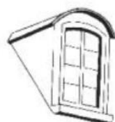
Lucarne à arc surbaissé
