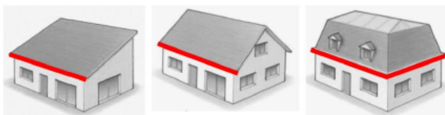
Égout du toit sur toiture mono-pente
